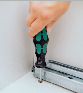
SOKKELPOTVERSTELLING Sokkelpootverstelling eenvoudig van binnenuit via de kast. Standaardsokkelhoogtes: 75, 100, 125, 150, 175 & 200 mm.
